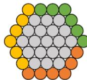
Fig. 1c Un cable metálico trenzado de calibre 4 se forma agregando 18 hilos al cable de calibre 3.
