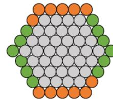
Fig. 1d Un cable metálico trenzado de calibre 5 se forma agregando 24 hilos al cable de calibre 4.
