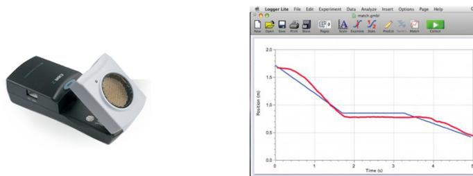
**Figura 4.** Sensor de movimiento (CBR-2) y ambiente del software *Logger Lite*
