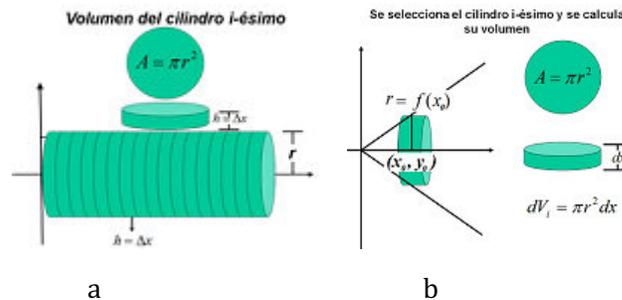
**Figura 6.** Elemento diferencial  $dV_i = \pi r^2 dx_i$  para calcular el volumen de un sólido por el método de discos
