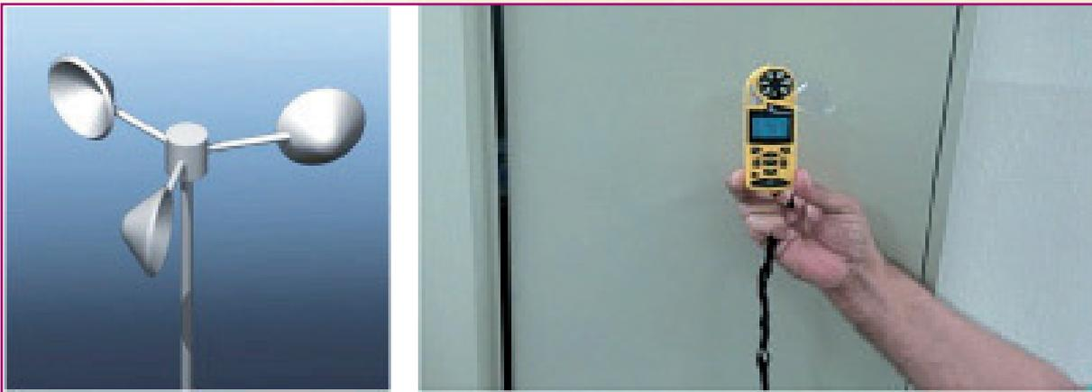
Figura 2.11 (Un anemómetro tradicional y otro digital)
